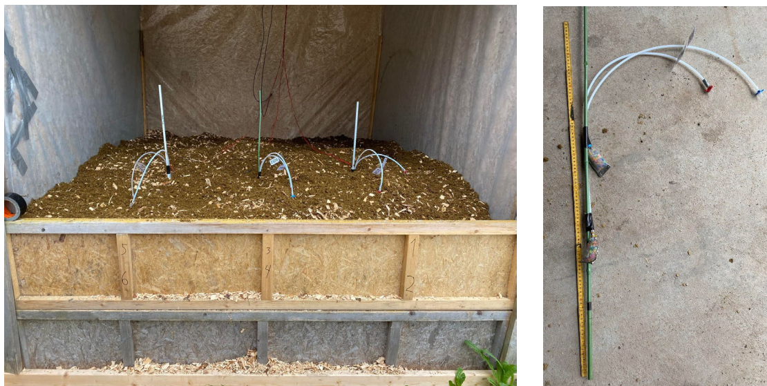
Figur 3. Binge med kompost av bioest fra husdyrgjødsel og måleutstyr for temperatur og gassutvikling (t.v). Nærbilde av slangene med nettingposer som ble satt ned i komposten (t.h.). Foto: Randi B. Frøseth.
