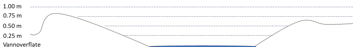
Figur 18: Tverrsnitt av vannmettet område og områder som kan bli vannmettet ved stigende vannmengde. Dersom terrenget består av løsmasser vil vann også trenge inn i grunnen.
