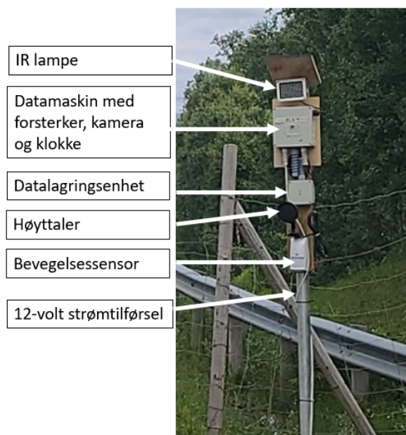
Bilde 1. Den bevegelsesaktiverte lydavspillende enheten består av: IR lampe, datamaskin med kamera, lydforsterker, kamera og CPU-klokke, datalagringsenhet, høyttaler, bevegelsessensor og strømtilførsel (+ og – kabel til 12-voltsbatteri).
