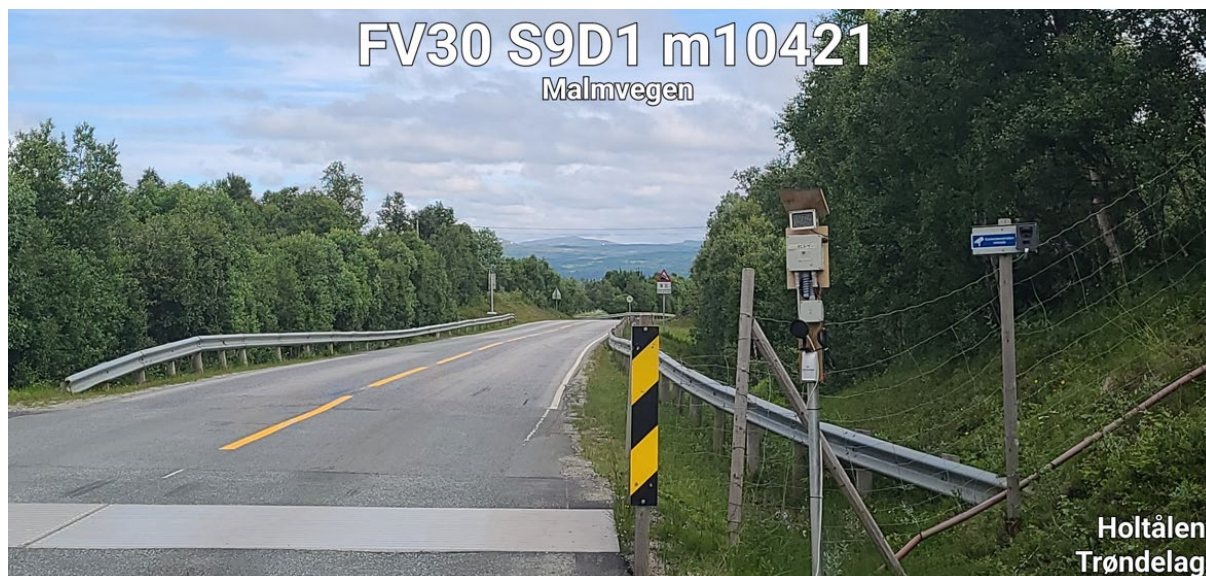
Bilde 2. Plassering av den bevegelsesaktiverte lydavspillende enheten ved lokaliteten Nesvoll ved Fylkesvei 30. Bevegelsessensoren dekket hele området foran ferista. Foto: Morten Aune.
