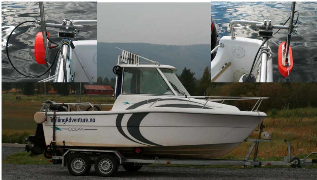
Figur 2. Typisk ekkoloddbåt for større innsjøer oppsatt med to svingere (tranceivere; bilder innfelt), en 11 grader rettet vertikalt på babord side og en 7 grader rettet horisontalt på styrbord side. Selve ekkoloddet (transducer) og prosesserings-PC er oppmontert inne i kabinen på båten.
