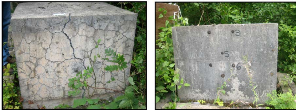
Figur 23 Bilder av 900 mm feltekuber fra BRE feltstasjon i Storbritannia etter 18 års eksponering. Venstre: referansebetong med 550 \text{ kg/m}^3 portlandsement. Høyre: 450 \text{ kg/m}^3 portlandsement + 150 \text{ kg/m}^3 flygeaske. Begge betonger med samme flinholdig sand. Foto fra Ideker et al. (2012).
