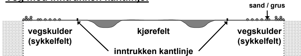
Figur 22: Slitasje (spordannelse) på veger med og uten inntrukken kantlinje.
