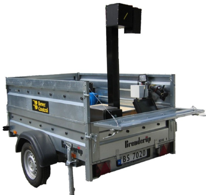
Figur 2 Bever 3D Win profiler montert på tilhenger. (Foto: Bever Control AS)
