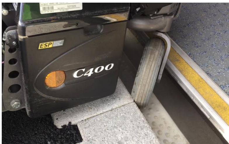
Figur 13 Hjul på elektrisk rullestol setter seg fast mellom buss og holdeplass. Foto: Statens vegvesen
