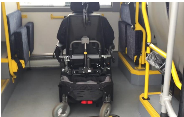
Figur 19 Begrenset areal til elektrisk rullestol i Volvo 8900, 15 m. Foto: Statens vegvesen
