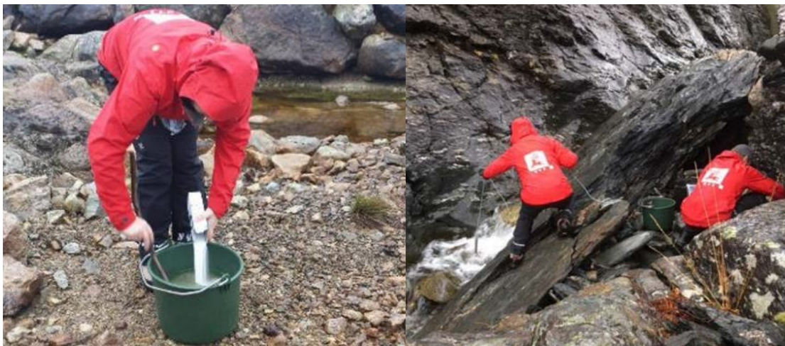
Figur 24. Bildene illustrerer kontrollmåling av minstevannføring i elva nedstrøms inntaket til et kraftverk ved hjelp av fortynningsmetoden. Først blandes en kjent mengde kjøkkensalt med vann (venstre bilde). Blandingen slippes ut der minstevannføringen slippes ut i elva. Utstyr for å måle ledningsevnen plasseres på egnet sted nedstrøms slippstedet (bilde til høyre). Målingen pågår fra saltblandingen slippes og til bølgen av økt saltkonsentrasjon har passert logger. Foto: NVE
