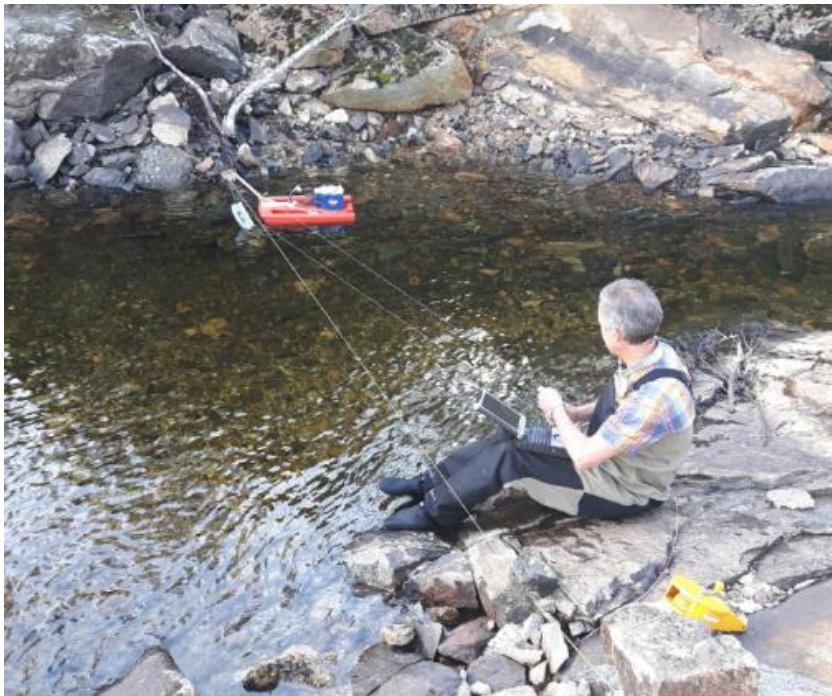
Figur 23. Bildet viser kontrollmåling av minstevannføring ved bruk av ADCP-utstyr i en liten elv. Foto: NVE
