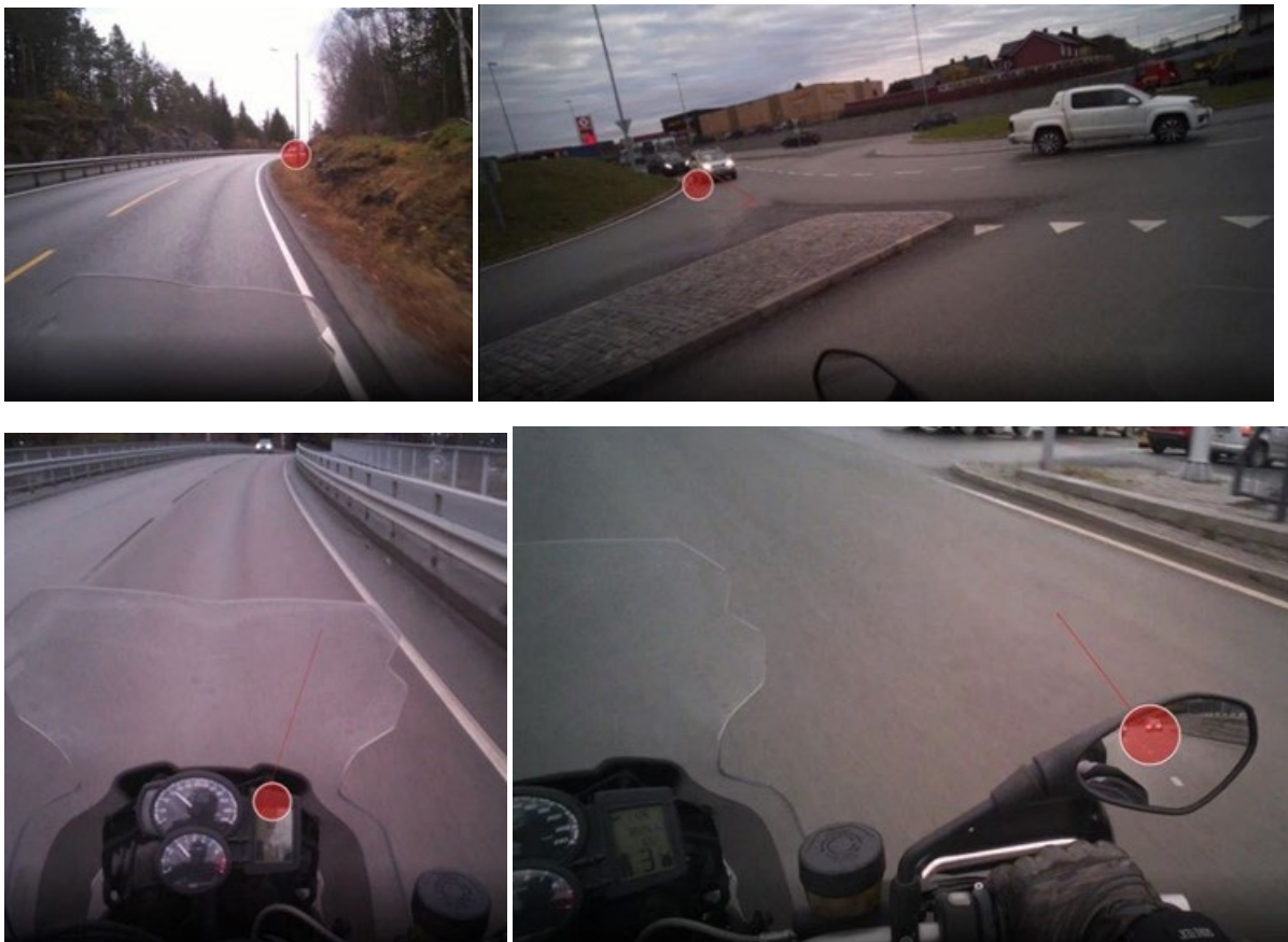
Figur 7: Bilder fra testforsøk gjennomført av Nord universitet og SINTEF med erfarne motorsyklistførerne i Trondheim. Øyesporingsbriller registrerer hva føreren ser på, i hvilke rekkefølge han ser på det, og hvor mye tid han bruker. Den røde prikken viser førerens blikkpunkter i sanntid (Bilder: SINTEF)
