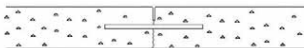
Figur 663.0 Eksempel på prefabrikkert dybelkorg. Merk at bøylene kappes under saging av fugen.
