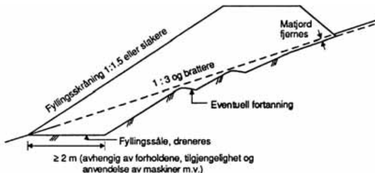
Figur 253.1 Fyllingssåle ved terrengskråning 1:3 og brattere
