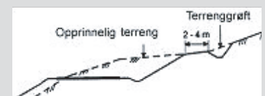
Figur 413.1 Plassering av terrenggrøft
