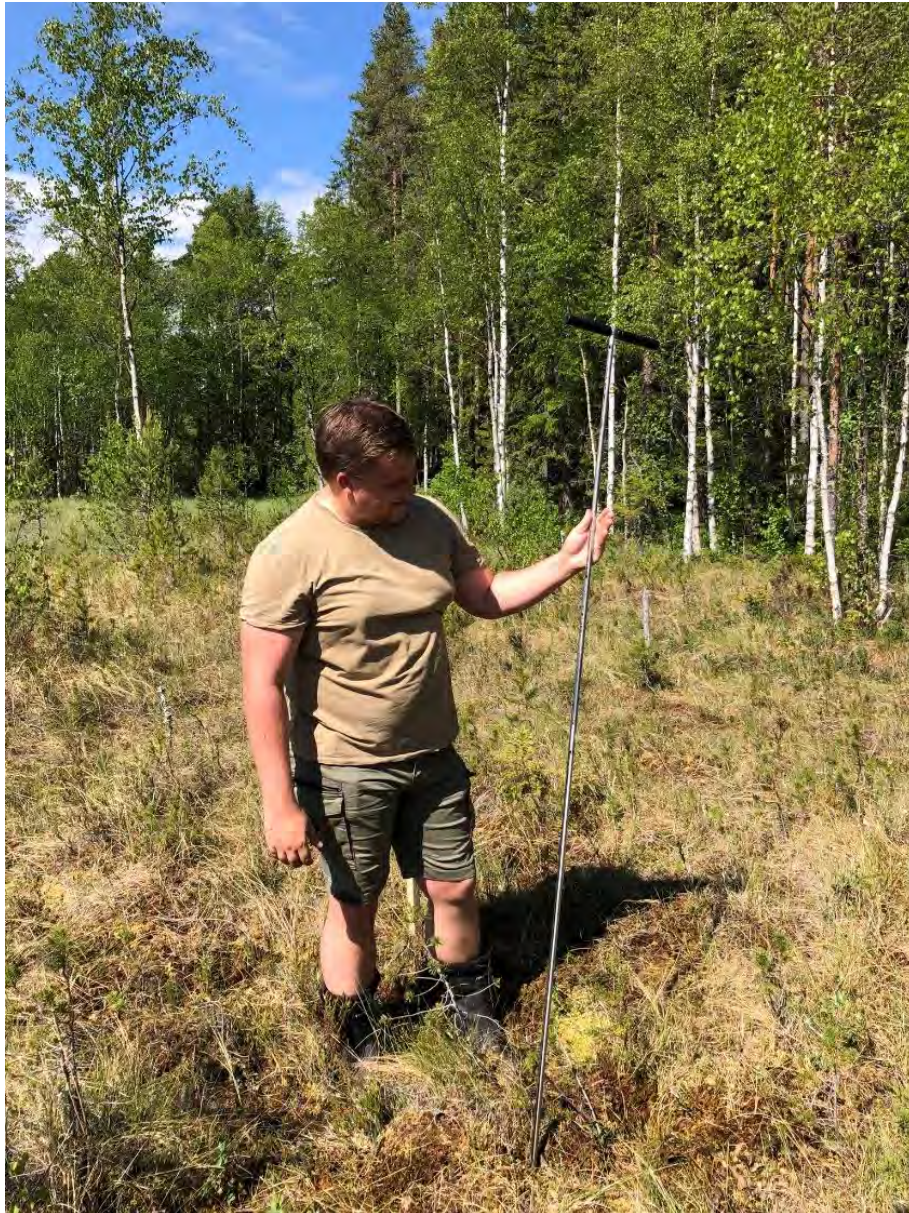
Figur 5 Torvsonde til dybdemåling (Avbildet: Martin Figge Eilertsen. Foto: Mona Bakke Myrvang)
