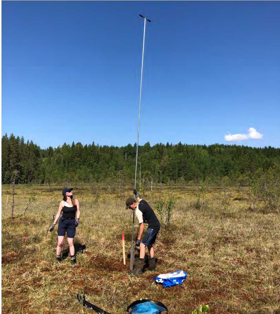
Figur 7 Uttak av torvprøve med Russerbor på Fløytskyr (Avbildet fra venstre: Anne Petra Øyen Jacobsen, Sondre Englund Brenni. Foto: Mona Bakke Myrvang)
