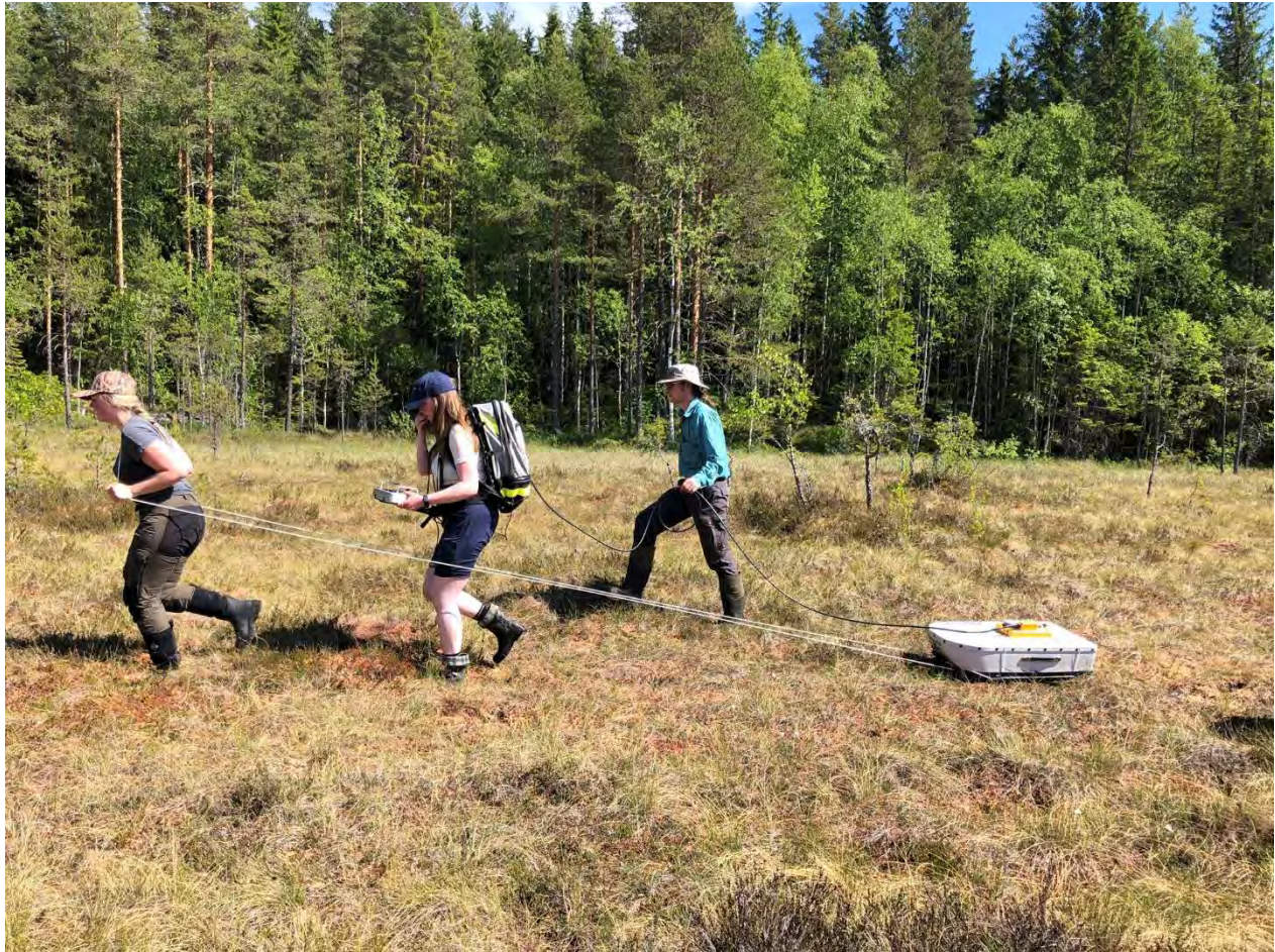
Figur 6 Malå Georadar til myrdybdemåling (Avbildet fra venstre: Siri Graff, Anne Petra Øyen Jacobsen, Marcel Schrijvers-Gonlag. Foto: Mona Bakke Myrvang)
