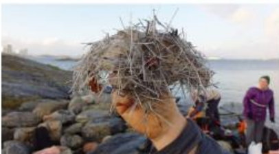
Denne er plastfiber som brukes til armering i sprøytebetong. FOTO: RUDOLF SVENSEN / NATURVERNFORBUNDET I ROSALAND
