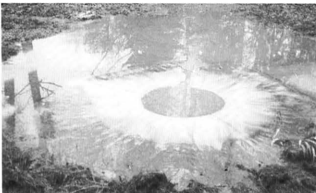
Slik kan det gå når vi borer ned i et vannførende lag som står under trykk.
