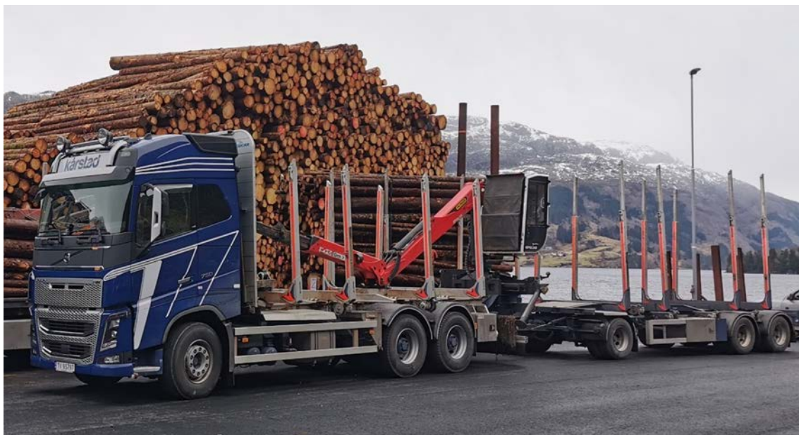
Figur 1.3: 3-akslet tømmerbil med 3-akslet tilhenger (korthenger). Foto: Torkel Hofseth.
