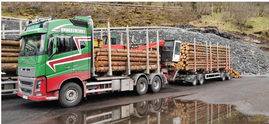
Figur 1.4: 3-akslet tømmerbil med 4-akslet tilhenger (langhenger). Foto: Torkel Hofseth.
