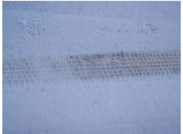
Figur 13: Avsetninger etter vask av dekk som hadde gått på våt, bar vegbane.
