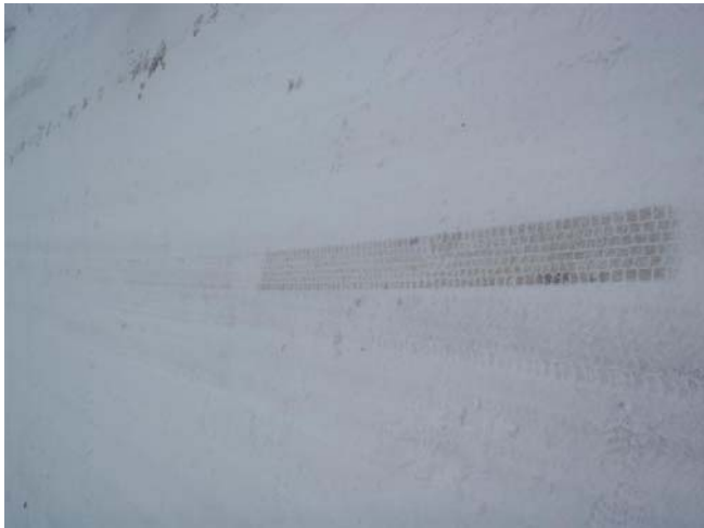
Figur 12: Avsetninger etter vask av dekk som hadde gått på salta, våt bar vegbane.
