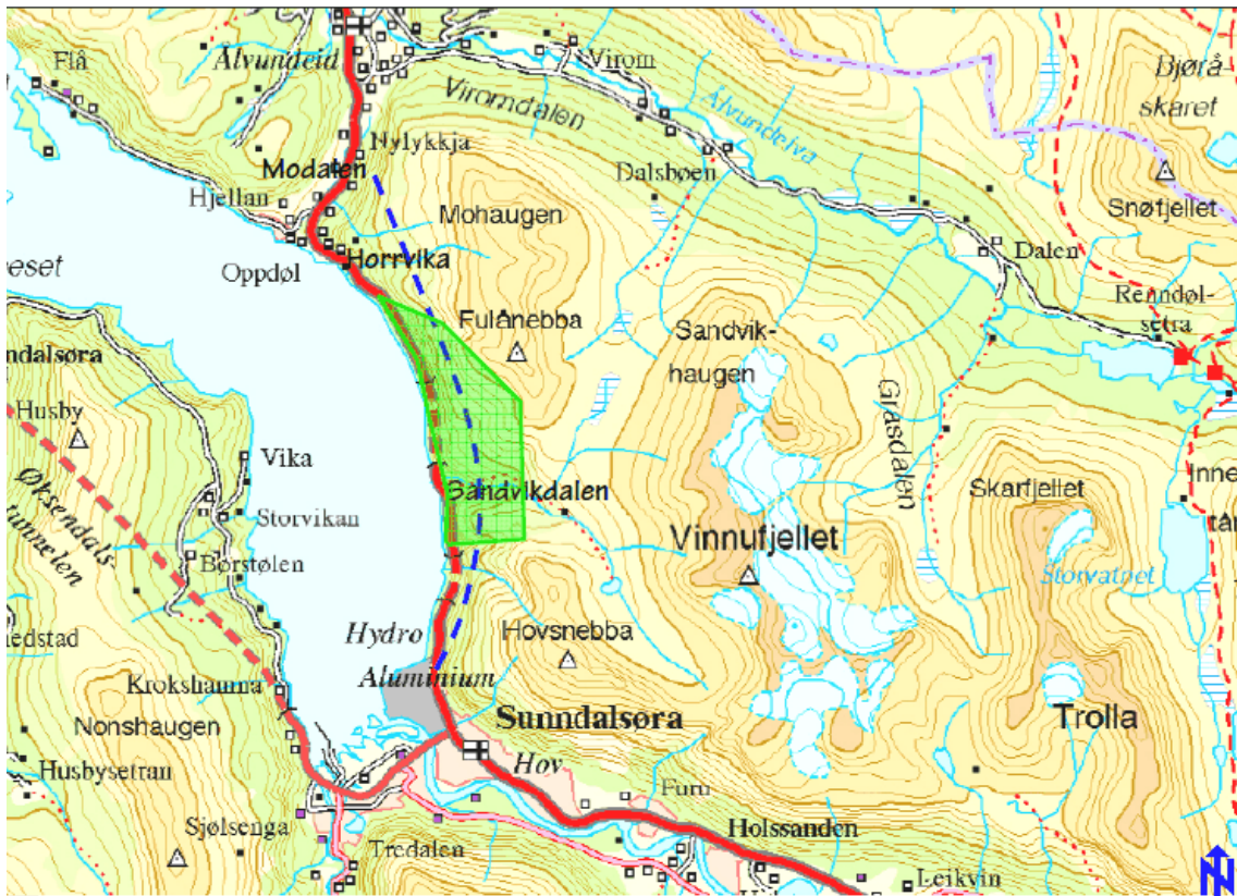
Figur 3: Kart over planområdet mellom Sunndalsøra og Ålvundeid. Den nye traséen angitt i blått, tunnel er stiptet. Landskapsvernområde er markert med grønt. Fra Ingeniørgeologisk rapport for reguleringsplan
