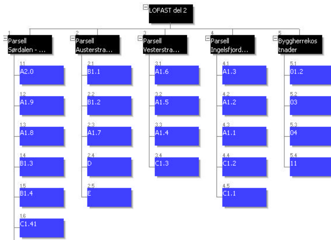
Figur 1. Prosjektnedbrytningsstruktur (PNS) for LOFAST del 2. De blå boksene angir hvor estimatene er lagt inn, mens de svarte boksene er summasjonsbokser.
