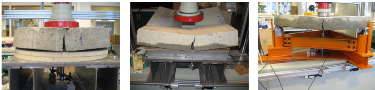
Figur 18 Energiabsorpsjonsprøving: sirkulær plate (NB7) – kvadratisk plate (NS-EN) – sirkulær plate (ASTM)
