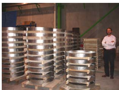
Stefan Bernard ved siden av noen av prøveformene som brukes til produksjon av prøveplater til testing av energiabsorpsjonskapasitet
