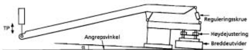
Figur 6.3 Prinsippskisse av screed på utleggermaskin
