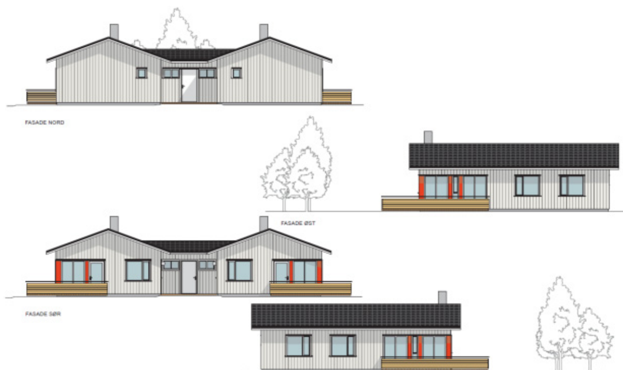
Figur V 12. Fasadetegninger TEK10-prosjekt, TEK 1.
