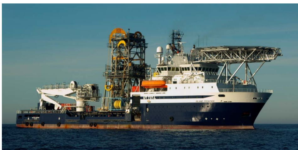
Figur 3.9 – Brønnintervensjonsskip. (Skipet på bildet har samsvarsuttalelse (SUT) fra Petroleumstilsynet). Foto: Island Offshore
