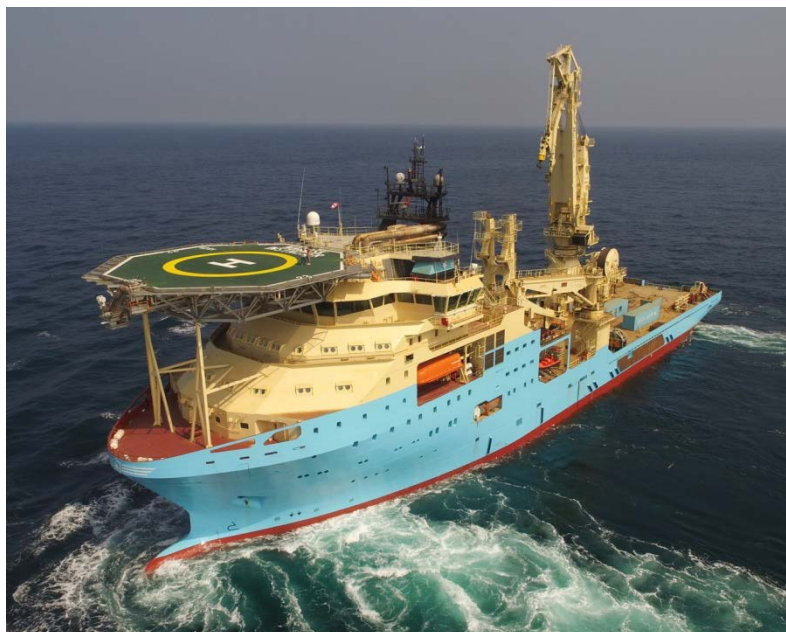
Figur 3.7 – CSV-fartøy. Fartøyet på bildet har en krankapasitet på 400 tonn og er utstyrt med DP3. Foto: Maersk Supply Service
