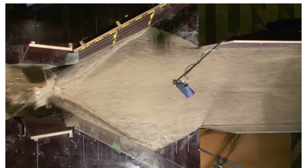
Figur 3: Bilde av skred 26 ( B = 300 mm, \beta = 30^\circ ); sidebølgene øverst med inntegnet målestørrelser, senterbølgen i midten, og oversiktsbilde nederst.
