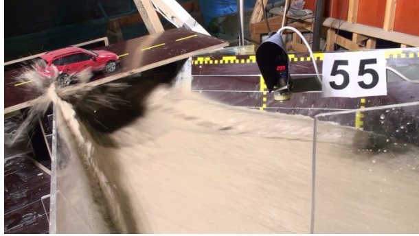
Figur 9: Sidebølgen i skred 55 slår opp til brudekket
