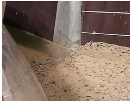
Figur 8: Avlagring i skred 42, sett mot høyre ledevoll rett oppstrøms brua
