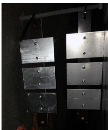
Figur 2. Prøveplater plassert bak hvelv i Lunnertunnelen; horisontalt (liggende på bakken) t.v. og vertikalt (hengende i en festebolt) t.h.
