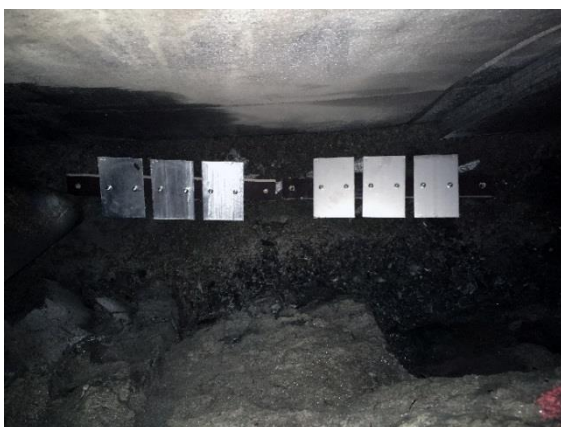
Figur 2. Prøveplater plassert bak hvelv i Lunnertunnelen; horisontalt (liggende på bakken) t.v. og vertikalt (hengende i en festebolt) t.h.
