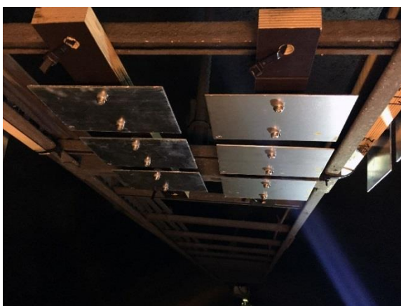
Figur 1. Prøveplater hengt opp i kabelstigen ca. midt i Lunnertunnelen. Prøveplater nær portal ble montert på tilsvarende måte.
