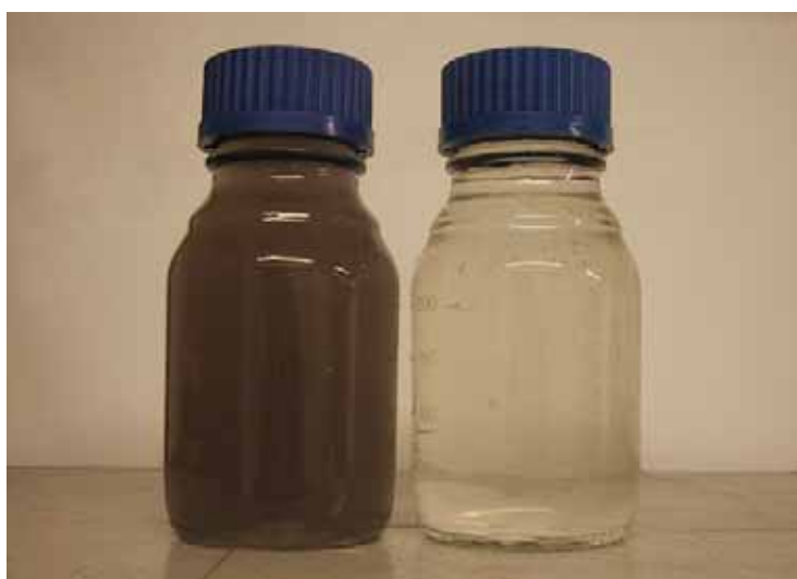
Figur 6. Vannprøver av innløpsvannet (venstre) og utløpsvannet (høyre) for avrennings-episoden 03.11.03. Rensegrad suspendert stoff = 95%.
