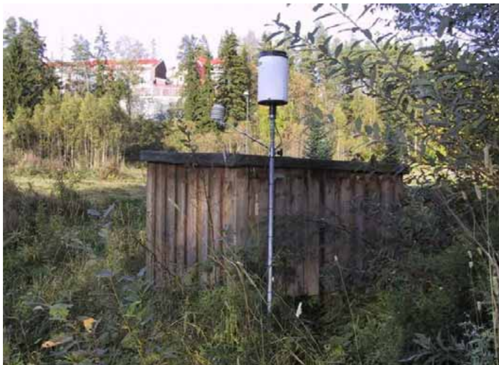
Figur 4. Målestasjon ved utløpet fra bassenget med vannførings-, nedbør- og lufttemperaturmåler.
