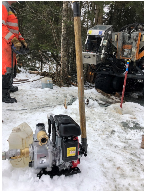
Figur 11 a) Kryssborkrone drill drain Ø90 med 19 mm spylehol. b) Honda VX15 og sandfilter for pumping av vatn ned til 6-8 m djup.
