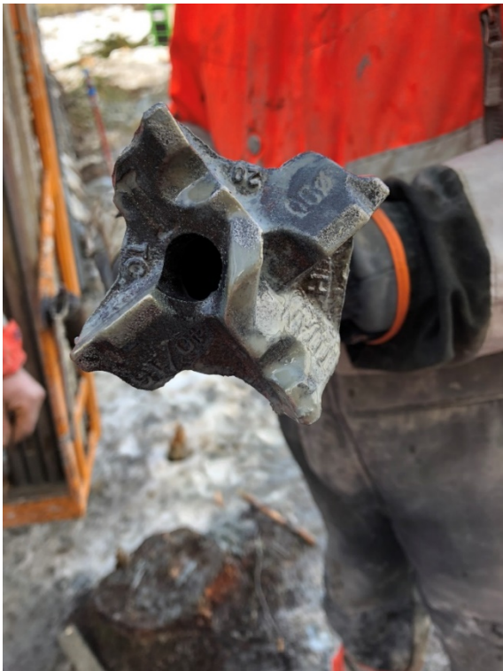
Figur 11 a) Kryssborkrone drill drain Ø90 med 19 mm spylehol. b) Honda VX15 og sandfilter for pumping av vatn ned til 6-8 m djup.
