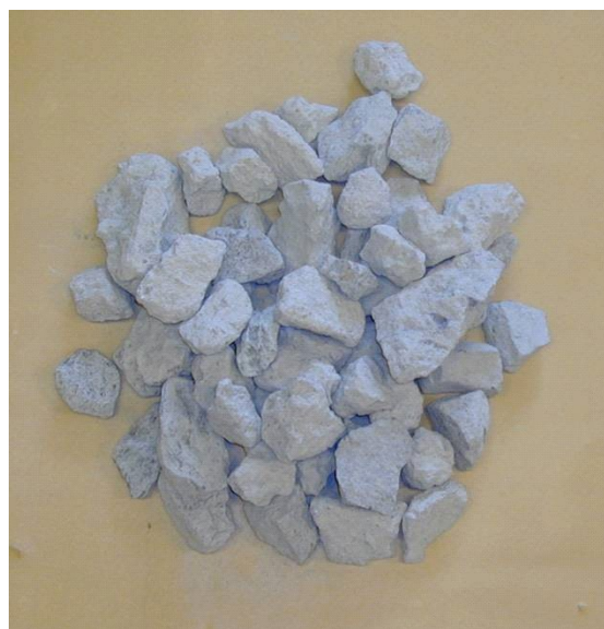
Figur 3: Los Angelesprøve av gjenbruksbetong (St Olav, Harald Hardrådes gt), før og etter forsøk (tilfredsstillende krav til bærelag, jfr. Tabell 4)
