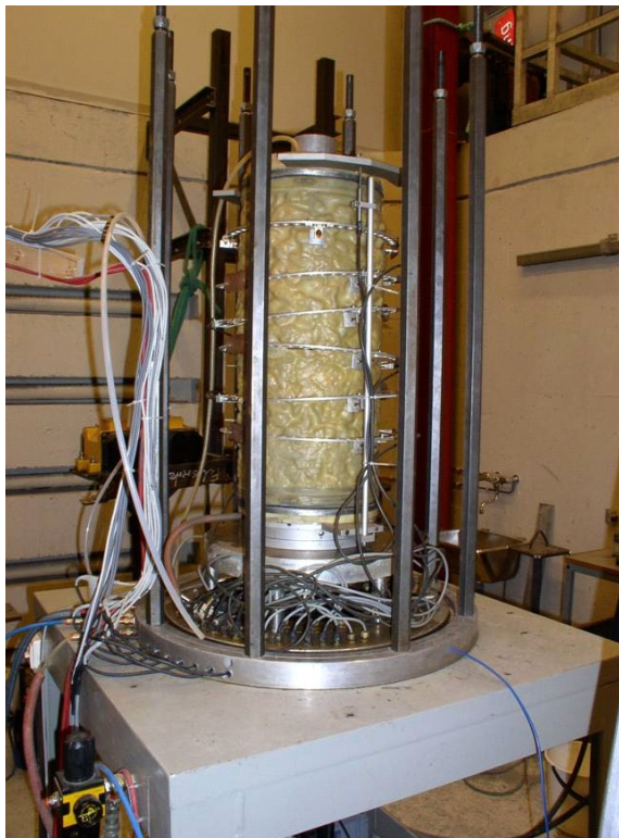
Figur 9: Stor treaksprøve montert i testrigg, gjenbruksbetong fra E6 Melhus
