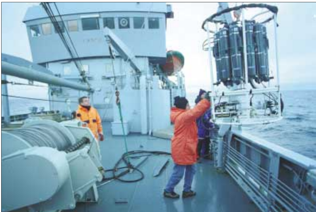
Figur 7a Oseanografisk måleutstyr heises over bord fra forskningsskipet Lance.
