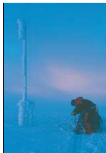
Figur 2b Bildet viser en av målestakene for massebalansemåling på Engabreen. To ganger i året gjøres det avlesninger i forbindelse med slike målinger.
