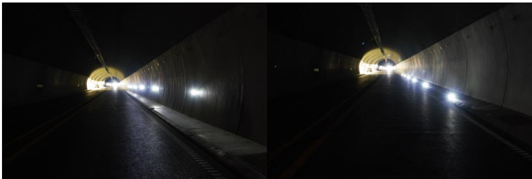
Figur 8 Foto av forsøk med ledelys i Rallerudtunnelen
