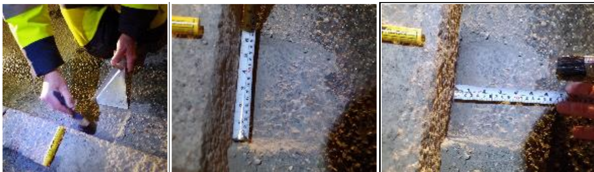
Figur 38: Prøvetaking av støvdepot (foto: Brynhild Snilsberg)
