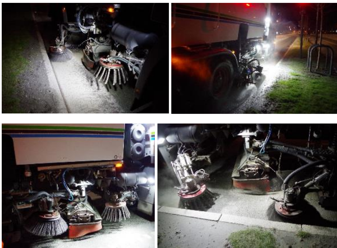
Figur 22: Ugrasskost til høyre, oppsug og tverrbørste i midten, og vanlig kost til høyre med påføring av vann. Etter den bakre kosten er det også dyser som spyle vegbanen (foto: Brynhild Snilsberg)
