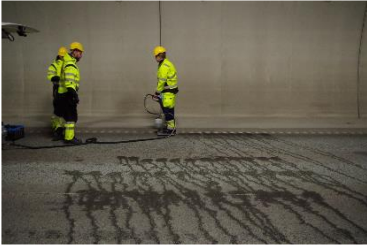
Figur 33: Prøvetaking av støv på bankett og vegbanen før rengjøring (foto: Brynhild Snilsberg)
