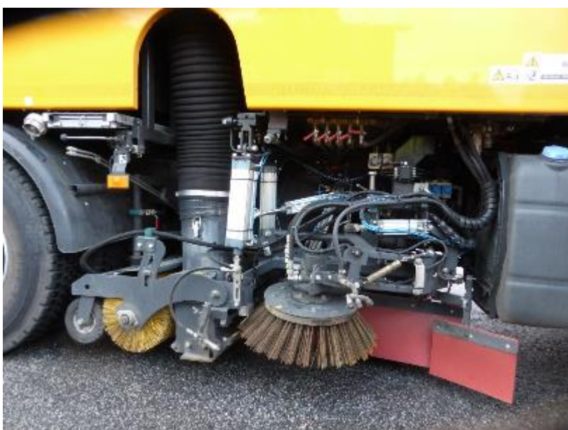
Figur 11: Feiesystem midt på bilen (foto: Brynhild Snilsberg)
