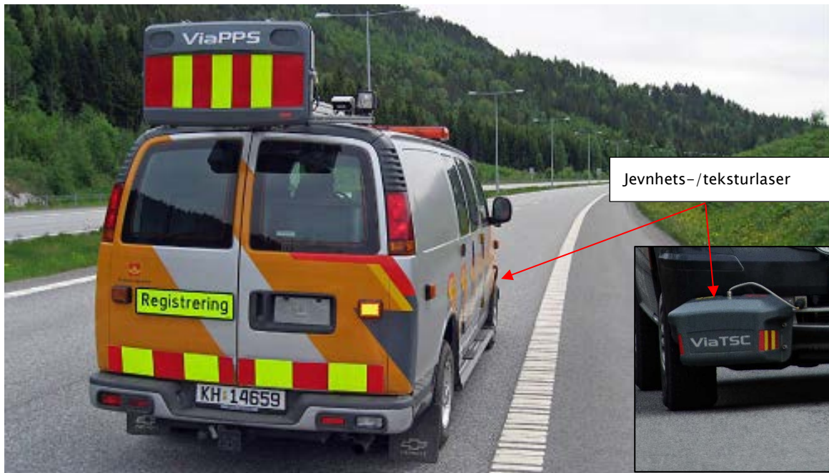
Figur 30: ViaPPS målebil for spor, tverrfall, jevnhet og vegbilder. Jevnhets-/teksturlaser innfelt (Foto: Torleif Haugødegård/Sigurd Skjelmo)
