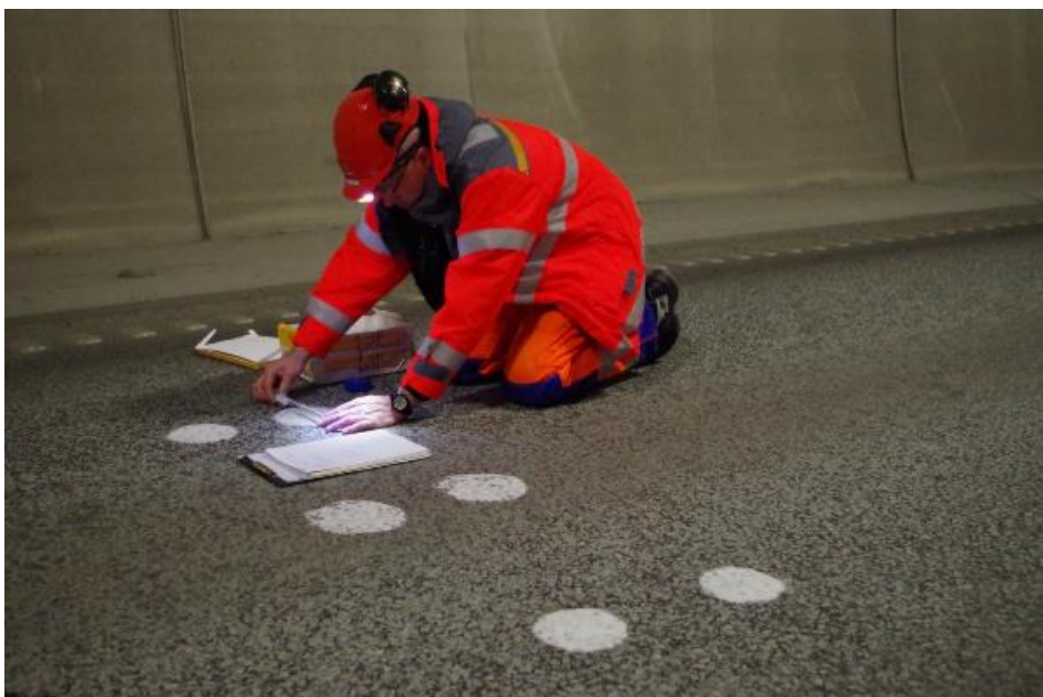
Figur 29: Ruhets-/teksturmåling (MTD) med Sandpatch (foto: Brynhild Snilsberg)
