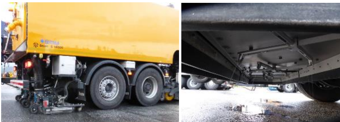
Figur 12: Rotorclean med baksug (foto: Brynhild Snilsberg)
