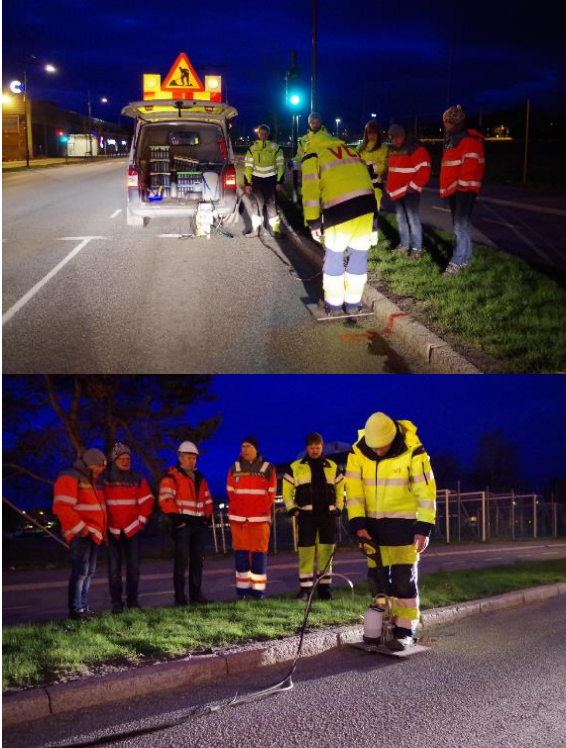
Figur 59: Måling med WDS langs kantsteinen i Haakon VII gate før rengjøring (foto: Brynhild Snilsberg)
