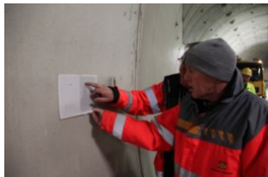
Helge Hoven og Per Brandli sjekker gråheten på tunnelveggen mot gråskalaen på arkene. Her før vask. (Foto: Ellinor Hansen)
