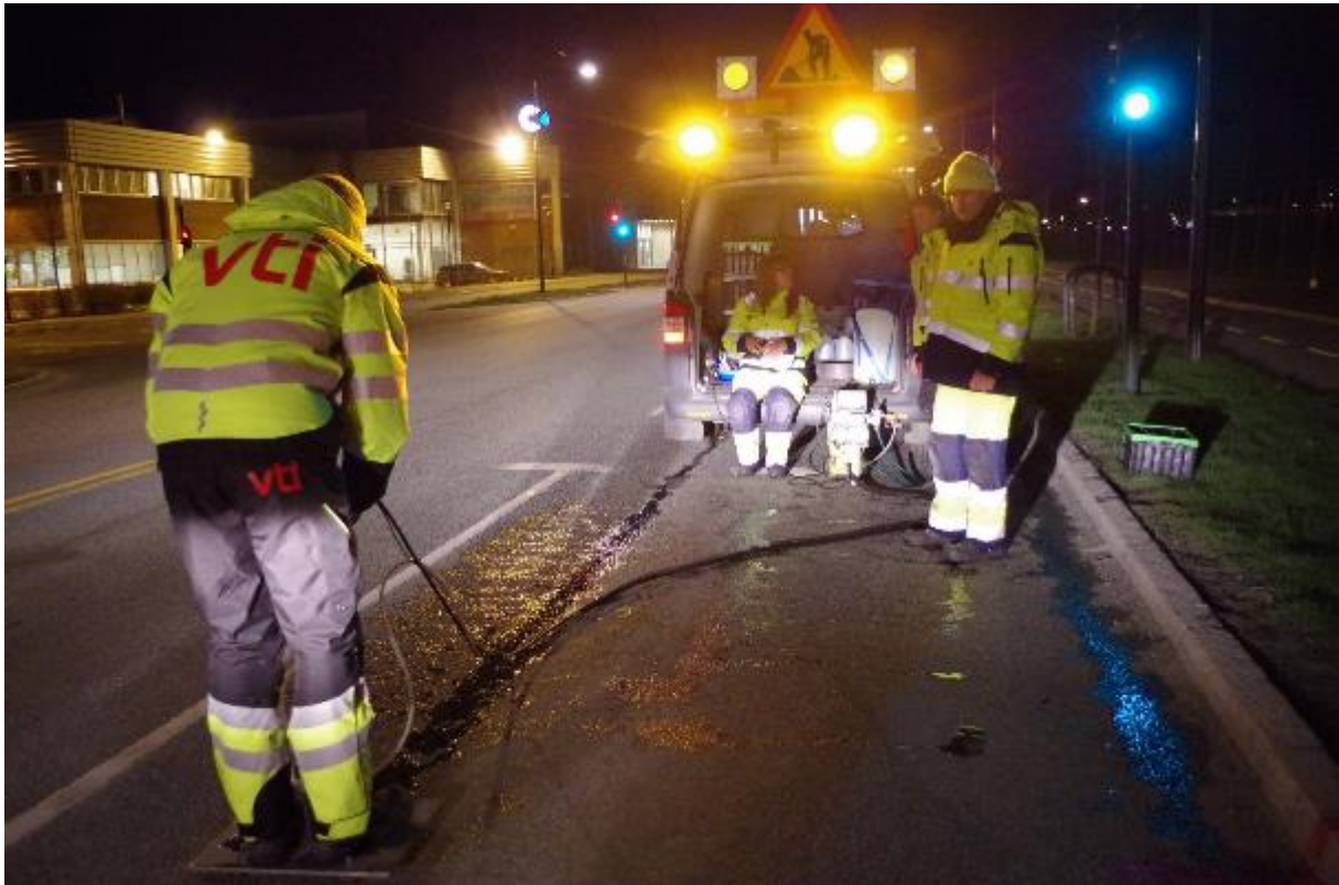
Figur 58: Måling med WDS i venstre hjulspor før rengjøring (foto: Brynhild Snilsberg)
