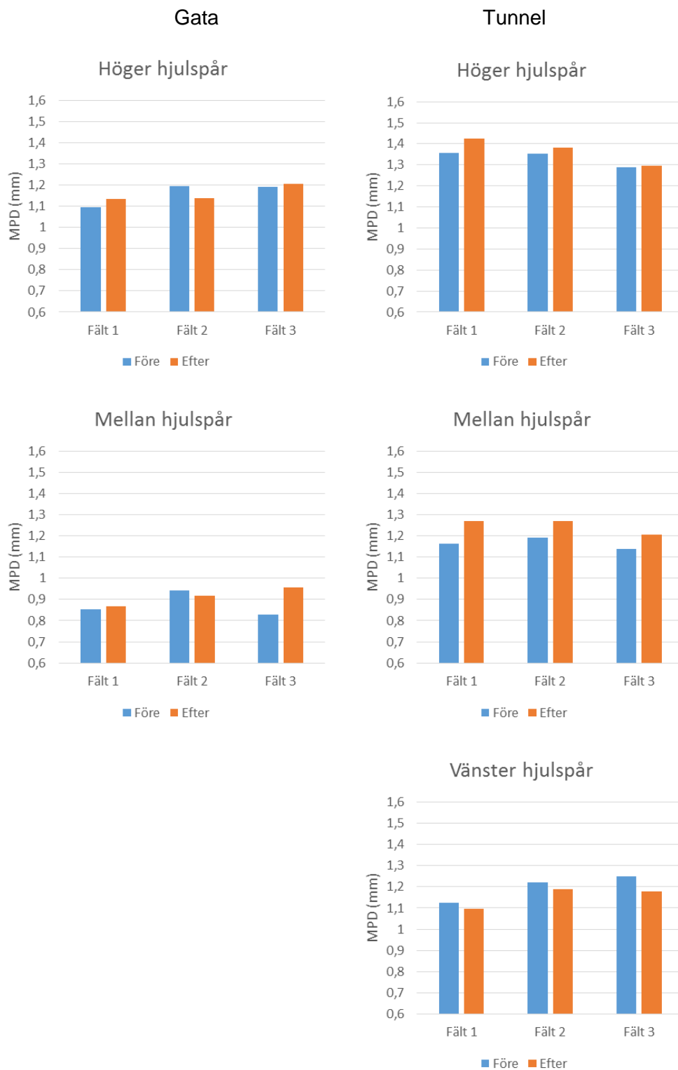
Figur19. Textur (MPD = mean profile depth) uppmätt före och efter städning i två ytor på gatan och tre ytor i tunneln.
