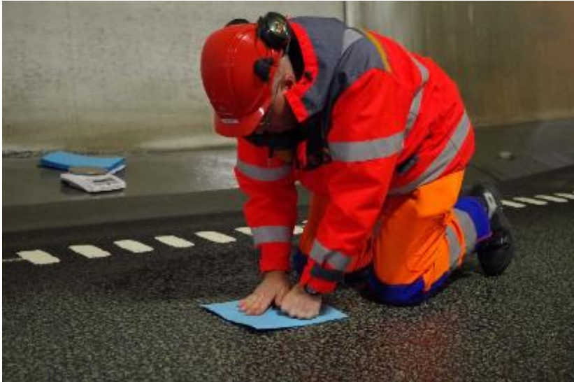
Figur 36: Måling av restfukt på vegbanen (foto: Brynhild Snilsberg)
