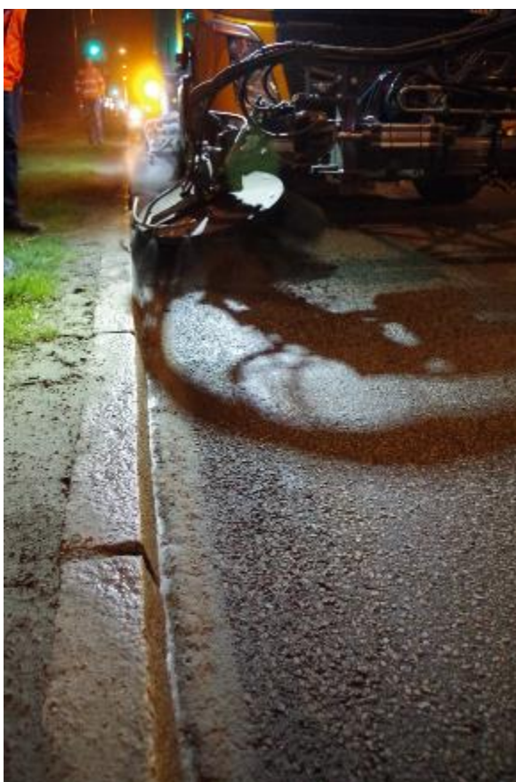
Figur 13: Frontbørste og midtbørste med vanddyser i bruk (foto: Brynhild Snilsberg)
