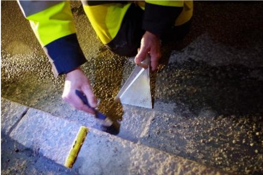
Prøvetaking av støv langs kantsteinen i Haakon VII gate før rengjøring (foto: Brynhild Snilsberg)
