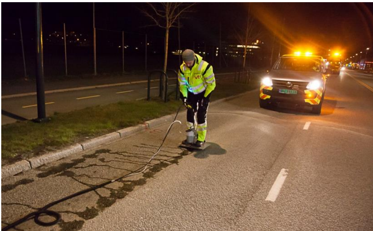
Figur 6. Provtagning i provytan mellan hjulspår på Haakon VII gate (Foto: Mats Gustafsson, VTI).
