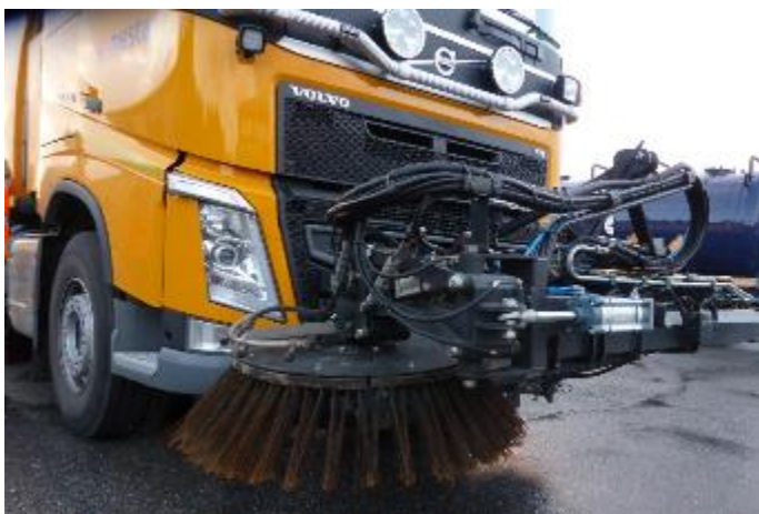
Figur 10: Styrbar frontbørste med vanddyse på bom (foto: Brynhild Snilsberg)
