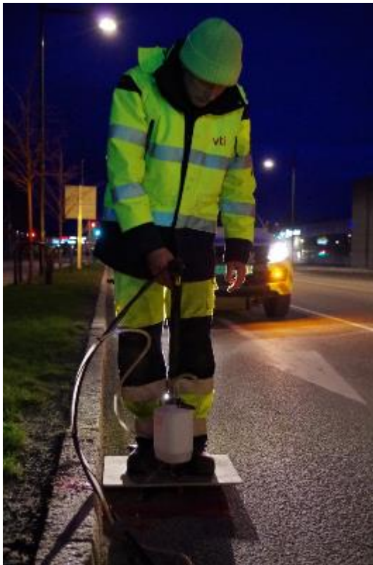
Figur 34: Prøvetaking med WDS i Haakon VII gate (foto: Brynhild Snilsberg)
