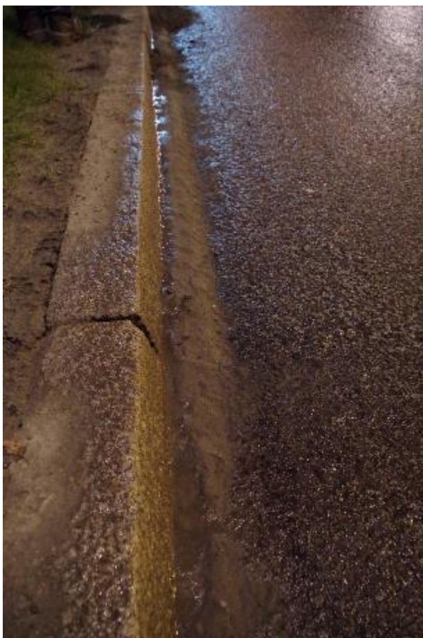
Figur 43: På grunn av manglende ugrasskost på Maskin 1 var det vanskelig å få fjernet støvdepotet langs kantsteinen som var blitt ganske hardt i løpet av vinteren. Men etter gjentatte overfarer ble det fjernet (foto: Brynhild Snilsberg)
