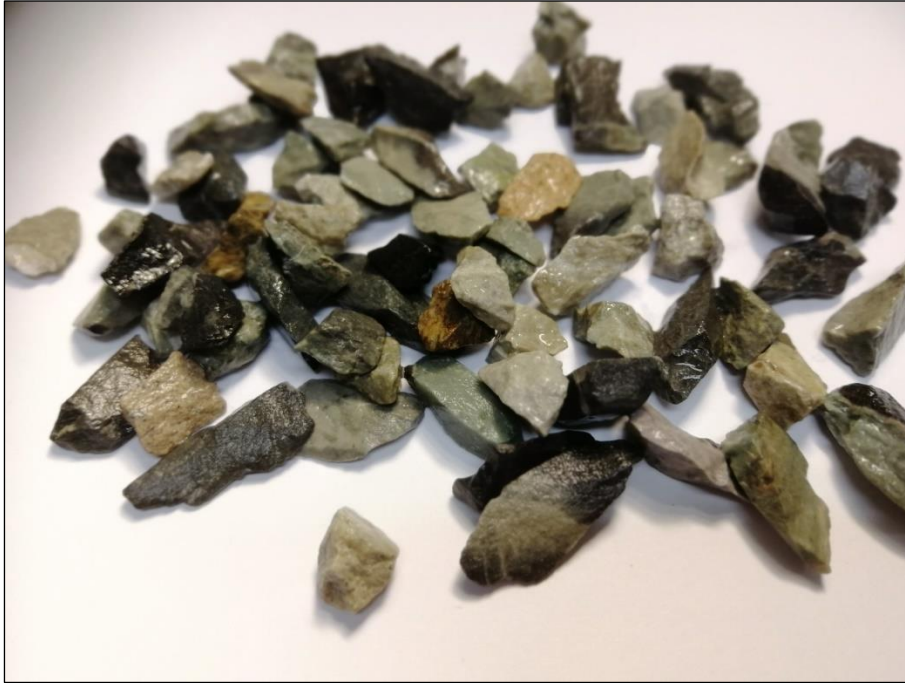
Figur 14. Materiale 5 viser variasjon i farge og kan være inhomogent.
