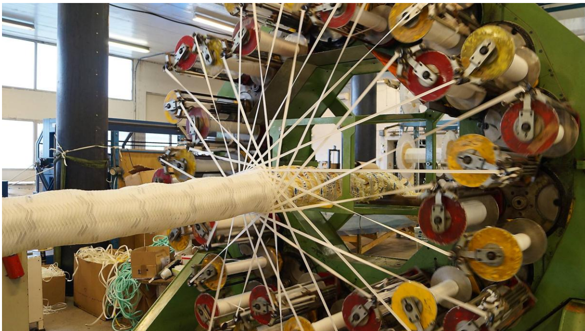
Det 140 millimeter tykke fibertauet Dextron 12 Plus er like sterkt som en stålwire med samme dimensjon, men mye lettere. Foto: OTS
