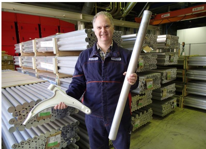
Multistep ekstrudering av smibolt er mulig. Foto: Raufoss Technology
