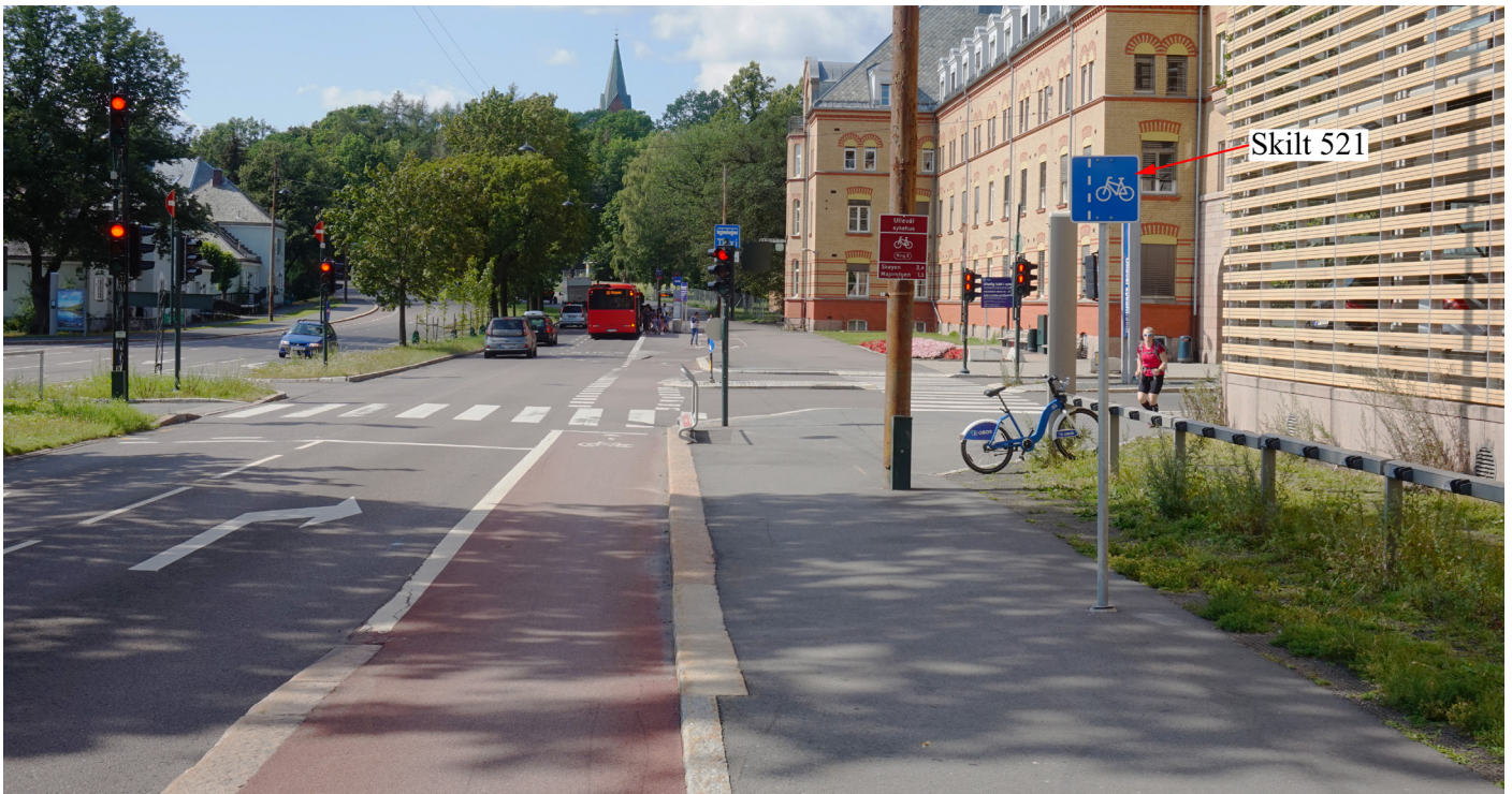
Figur 21. Bildet viser at sykkelveg rampes ned til skiltet sykkelfelt rett før lyskrysset. Foto: Tonje Lysø
