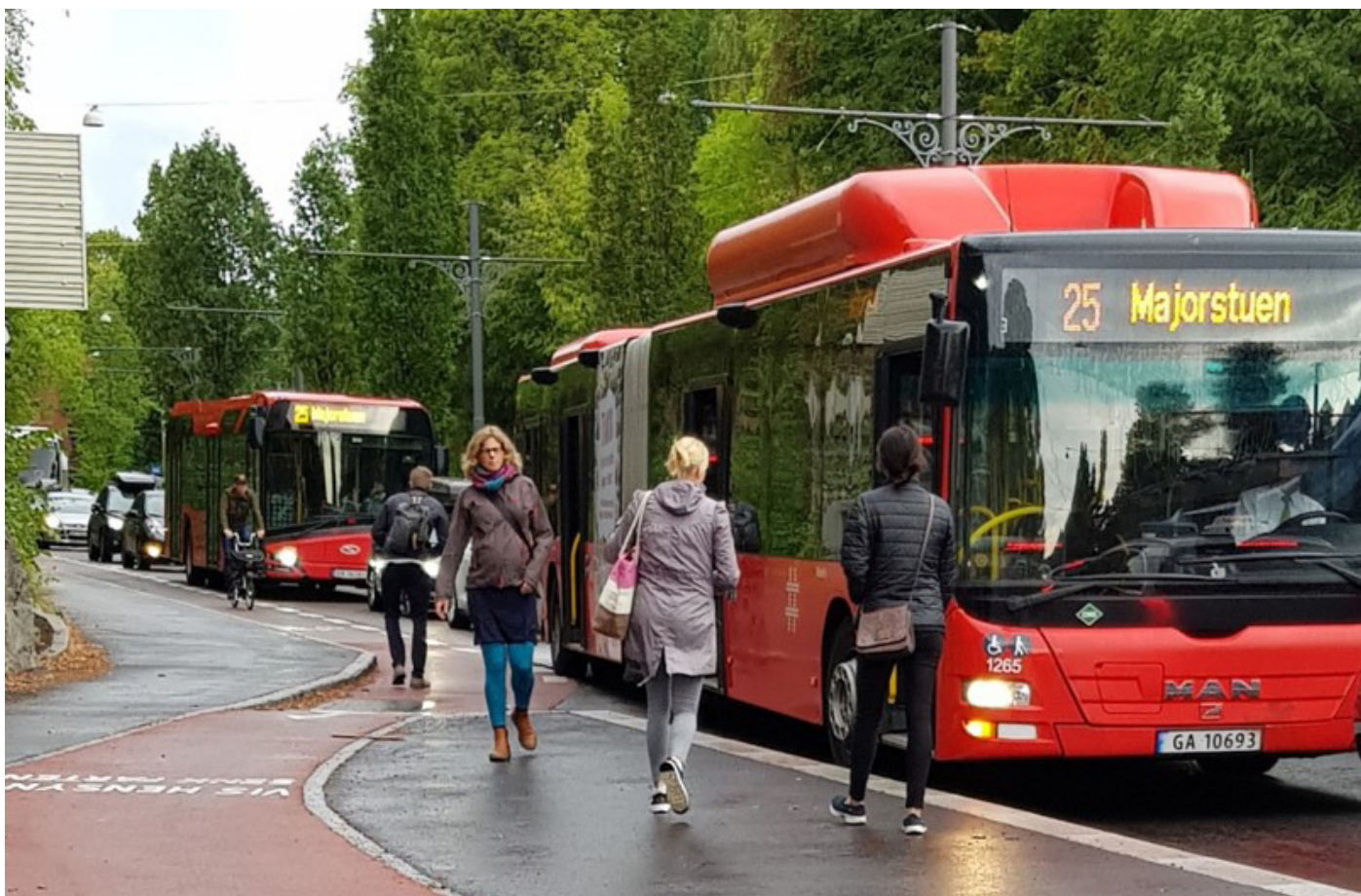
Figur 40. Bildet viser at bussen stopper for tidlig, og passasjerer slippes av i sykkelfeltet. Foto: Lars Olav Farstad, Sognsveien i Oslo.
