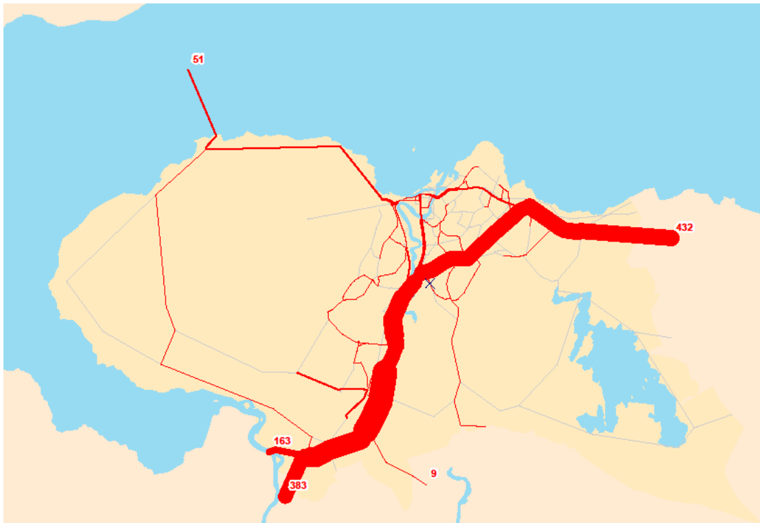
Figur 5.1: Nettutlagte turer (i 1000) utført med store godsbiler i Trondheim kommune i 2016. Datakilde: Lastebilundersøkelsen 2016.
