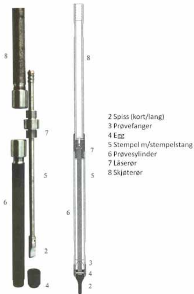
Figur 35 Ramprøvetaker for borrhigg
