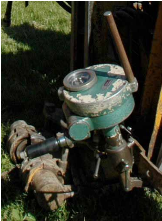
Figur 45a Vingeborinstrument med elektrisk motor.
