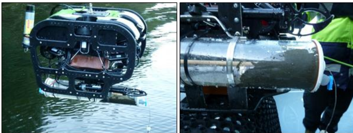
Figur 9. Prøvetaking med pleksiglass pushcorer montert på ROV.
