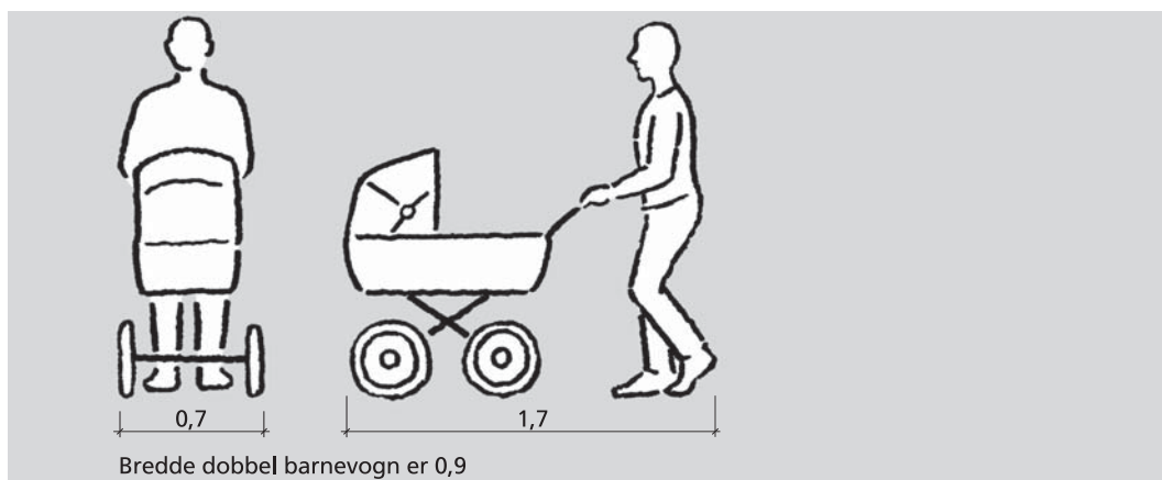
Figur E.4: Dimensjonerende mål for gående med barnevogn (mål i m)
