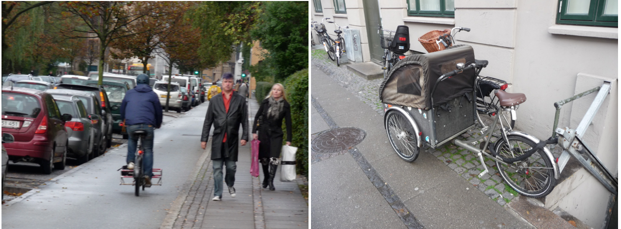
Figur 5.11: ”Fraktsykler” i København. Til venstre sykkel med 2 hjul og fraktbrett. Til høyre sykkel med 3 hjul og ”kabin”, i dette tilfellet for barn. Samme sykkel brukes for varetransport. I dette tilfellet er det også koblet på en ”slepesykkel” for litt større barn.
