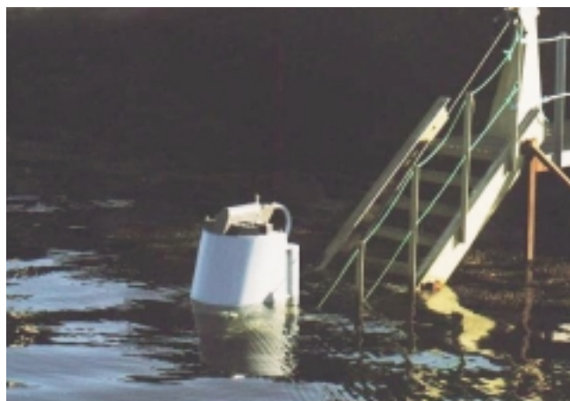
ConWECs bølgekraftmodell i skala 1:6. En flottor på en svingende vannsøyle driver et stempel til å pumpe sjøvann.
