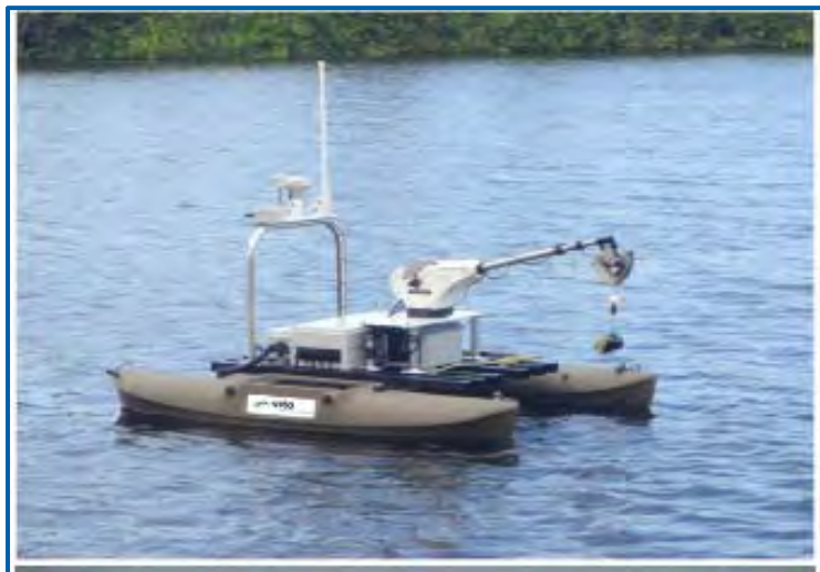
Figur 2. Ulike typer autonome farkostar som opererer på sjøoverflata. Øvst: Sailbuoy, utvikla av CMR instituttet i Bergen. Midten: Wave Glider, utvikla av Liquid Robotics, USA. Under: Den belgiske (VITO) AquaDrone farkosten.
