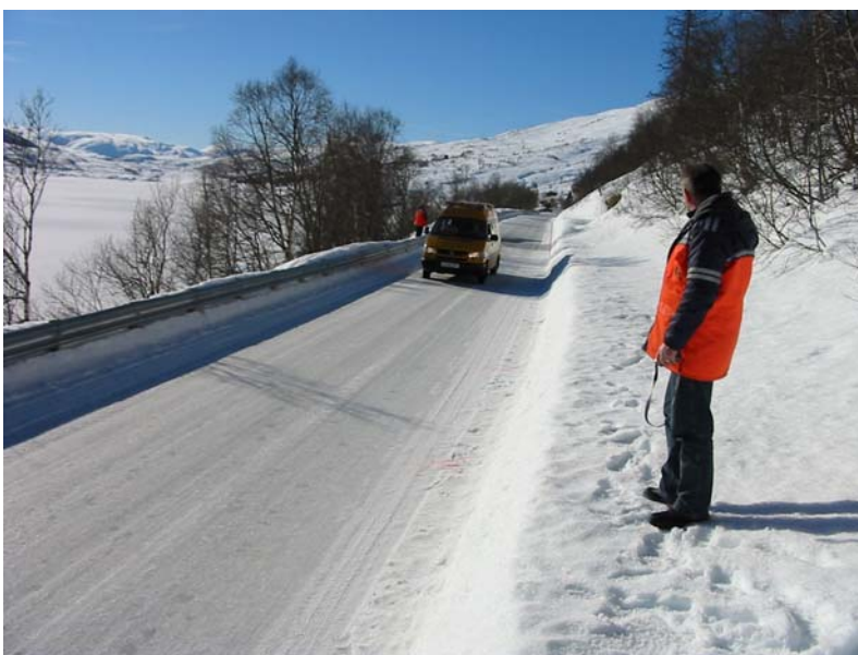
Figur 2: Måling av bremselengder på Voss den 27.02.2003
