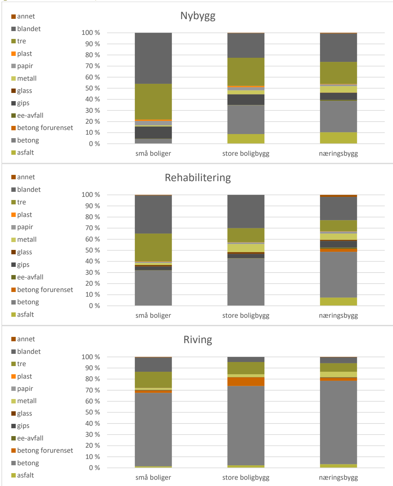
Figur 2.4 Erfaringsstall, forventet generert avfallsmengde i kg per materialtype per kvadratmeter fra byggeaktivitet etter aktivitet, i 1000 tonn.
