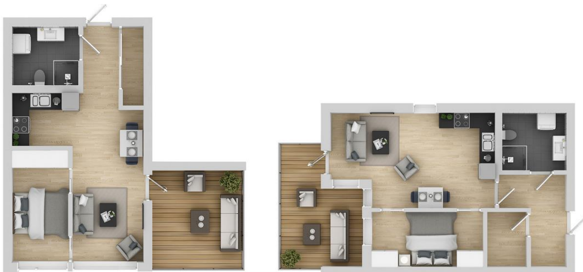
Figur 4.2-7 To leilighetsplaner fra Skiparviken Til venstre bygg A1, leilighet 103 på 39 kvm, som er ikke-tilgjengelig. Til høyre bygg A1, leilighet 304 på 44 kvm, som er tilgjengelig.
