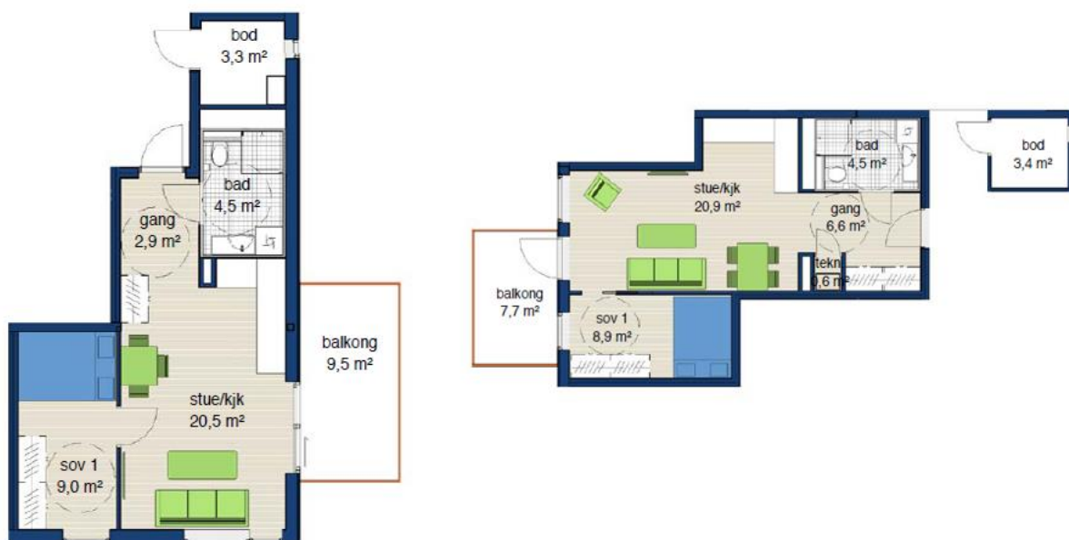
Figur 4.1-1 Elvesvingen. Leiligheten til venstre er på 38,8kvm og leiligheten til høyre er på 43,8 kvm
