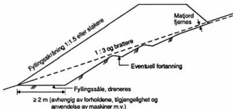
Figur 253.1 Fyllingssåle ved terrengskråning 1:3 og brattere
