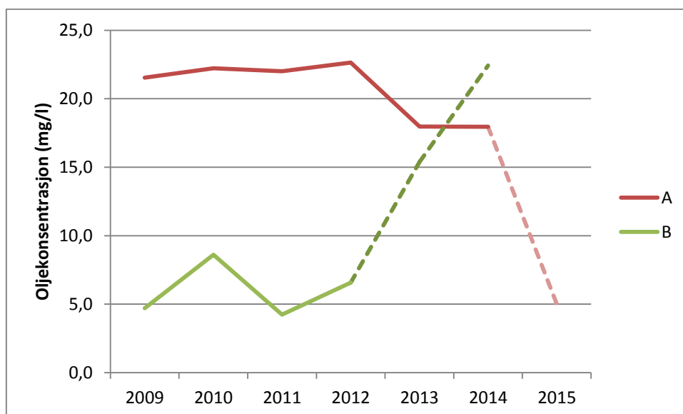
Figur 7 Oljekonsentrasjon (mg/l) for to felt før (heltrukken linje) og etter (stiplet linje) installering av ny plattform med ny renseteknikk for produsert vann (DNV GL, 2015).
