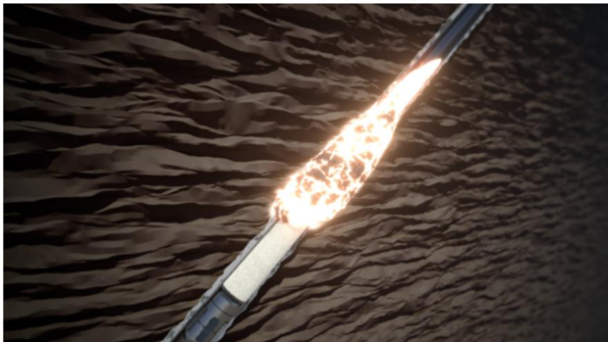
> Figur 6-5: Illustrasjon av Interwell P&A sammensmeltingsmetode [23]
