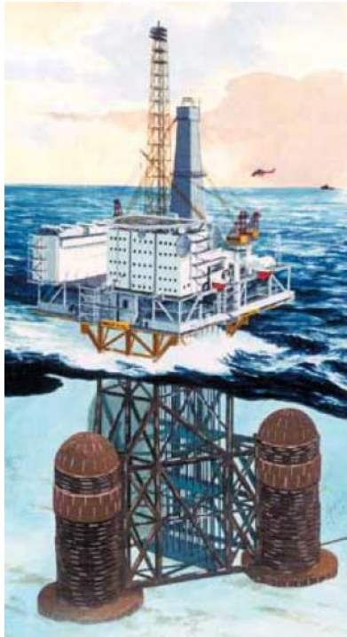
> Figur 8-14: Maureen stålpattform med celler
