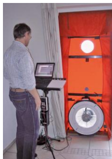
Figur 10 Tetthetsmåling i bygg med "Blower door" utstyr.
