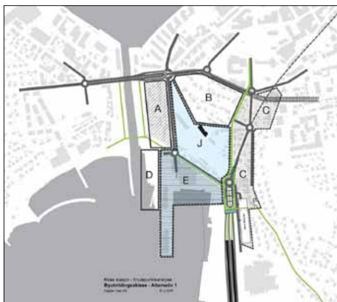
Figur 41: Prinsippsskisse for byutvikling (ref. s). Grønne linjer viser gang- og sykkelvegnett, grå linjer viser kjøreveg og felt A-D og J viser områder for byutvikling. Grunnlag for utarbeiding av utforming av vegsystem i konseptene.
