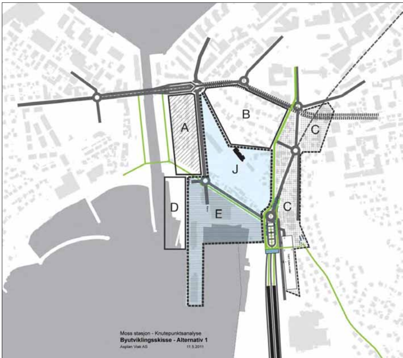
Figur 72: Prinsippkisse for byutvikling benyttet til utforming av vegsystem i konsept 2, 5 og anbefaling (Ref. s). Grønne linjer viser gang- og sykkelvegnett, grå linjer viser kjøreveg og felt A-D og J viser områder for byutvikling.
