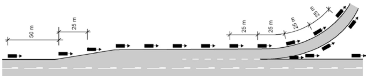
Figur 2-2.23. Plassering av kantstolper på rampe
