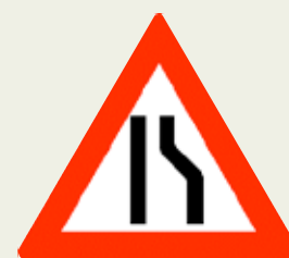
106.2 (Innsnevring på høyre side)
