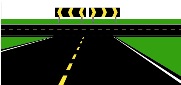
Figur 2-2.5 Eksempel på bruk av bakgrunnsmarkeringer i T-kryss
