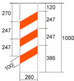
Figur 2-1.11 Størrelse og utforming av skilt 136. Mål i mm
