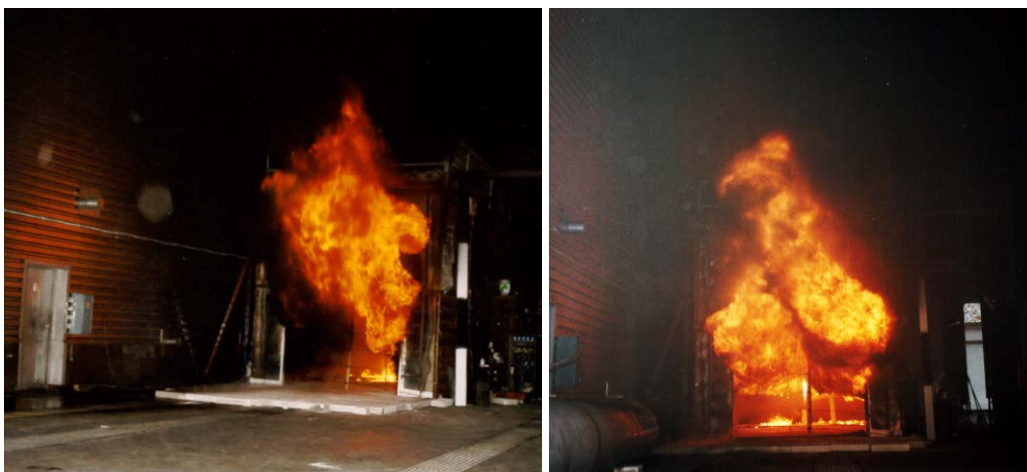
Figur 3-8: Bilder fra "Blast and Fire" prosjektet midt på 1990-tallet. Bildene viser innelukking av væskedamsbrann i et isolert rom. Foto: SP Fire Research.
